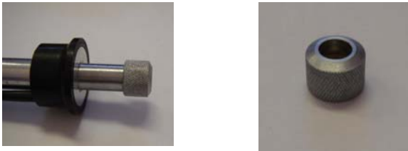
Рисунок 3. Вид преобразователя с дополнительной конусной насадкой
