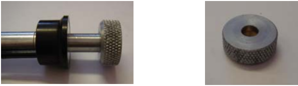
Рисунок 2. Вид преобразователя с плоской насадкой
